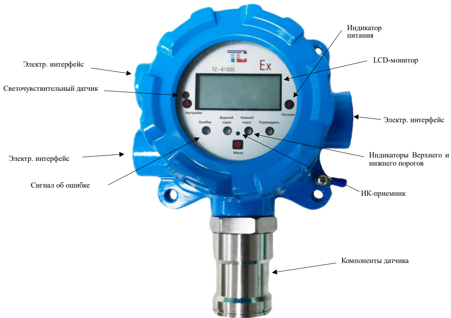
Рис. 2: Внешний вид газоанализатора
